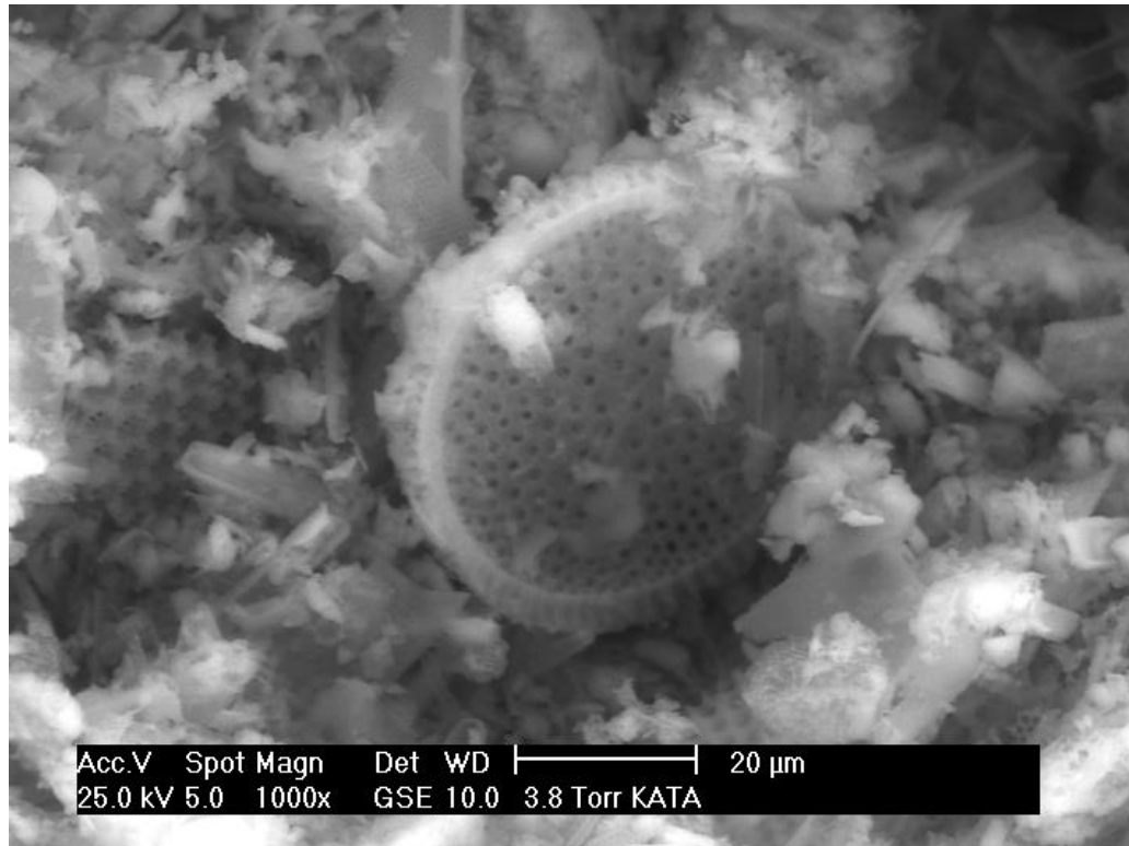
Figura 12. Micrografía a 1000X usando MEB de diatomitas Celite®. Fuente: tomado de la referencia [60].
