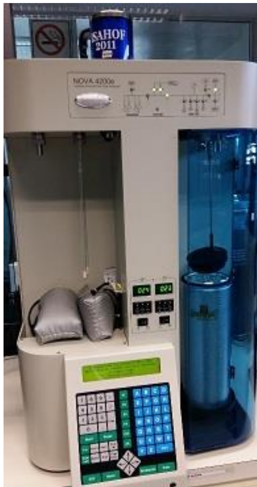
Figura 29. Sistema Quantachrome NOVA modelo 4200e. Fuente: Tomada en el Centro de Investigación en Ciencia Aplicada y Tecnología Avanzada del IPN
