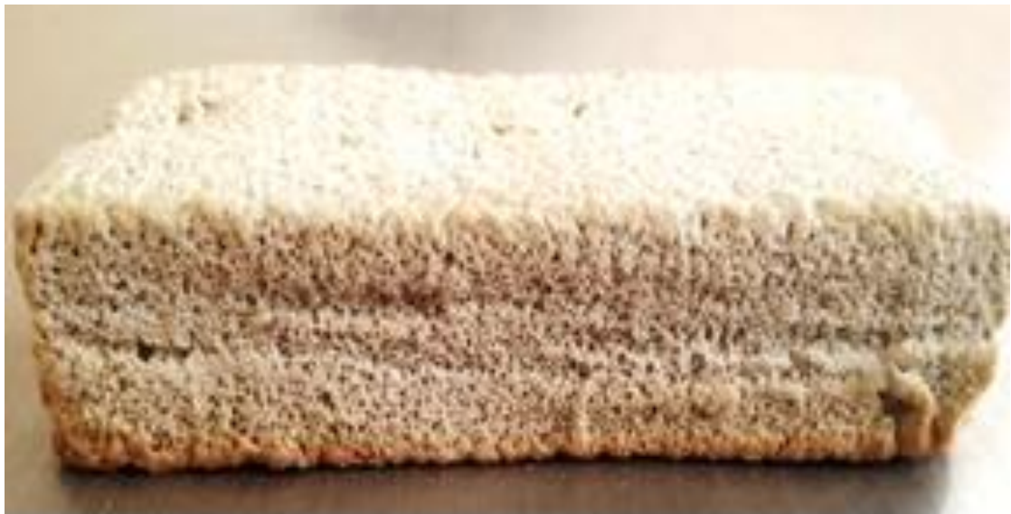
Figura 7. Espuma cerámica, elaborada por el método de réplica usando matriz espuma de poliuretano, inmersas en suspensión de arcillas caoliníticas y diatomitas. Fuente: Tomada en el laboratorio INCITEMA-UPTC-Tunja.
